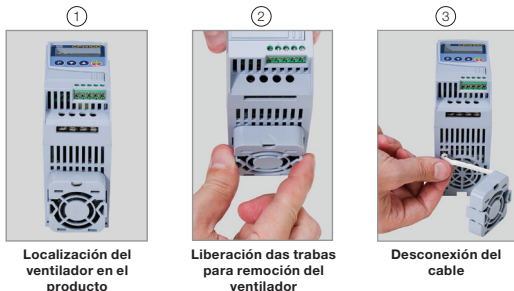
Figura 6.1: Retirada del ventilador del disipador
