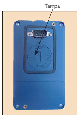
Figura 28: Localização da tampa de acesso à bateria
