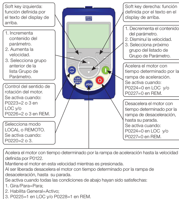
Figura 26: Teclas y funciones de la HMI
