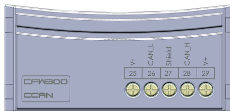
Figura 2.2: Detalle do conector CAN
