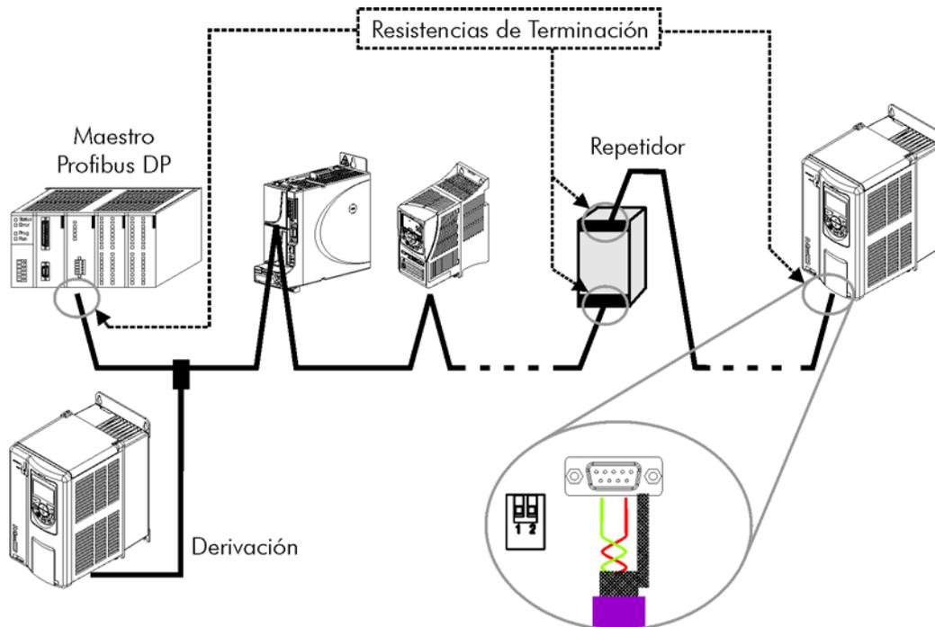
*Figura 3.1: Ejemplo de conexión en red Profibus DP*
