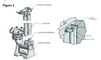
2-Determine la posición final del Codo de descarga teniendo en cuenta las dimensiones de la bomba, ya que un error en la posición podría dificultar la tarea cuando se requiera sacar a esta por la abertura. Verifique con una plomada la verticalidad de los Caños guía.
