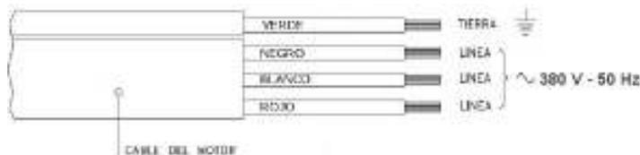
**La instalación debe estar provista de un interruptor (llave termo magnética) que provea una desconexión de todos los polos de la red de alimentación con una separación de al menos 3mm entre los contactos, de acuerdo a las normas nacionales vigentes.**
