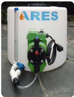
Figura 8.1.1 Adición de una pipeta graduada para la calibración de la bomba dosificadora.
