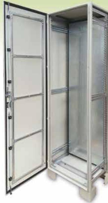
• **Construidos** por marcos formados con perfiles fabricados en chapa D.W.G N° 14 (2mm) de espesor con múltiples pliegues y soldados ofreciendo una alta resistencia mecánica. Punzonados modularmente, con perforaciones cuadradas de 8x8mm y redondas Ø 5,25mm, alternados con espacios de 25mm permiten utilizar tuercas jaula o tornillos autorroscantes respectivamente, garantizando una instalación rápida de accesorios.
